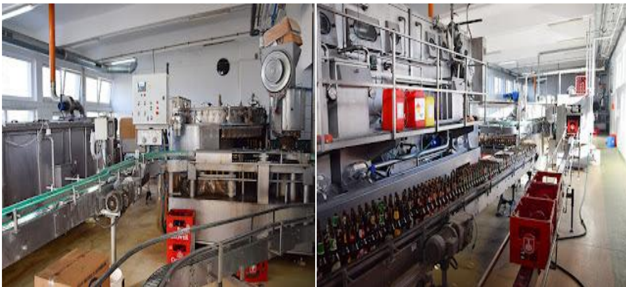
Automatyczne maszyny do mycia butelek i nalewania piwa. Zdjęcia: T. Waszkiewicz
