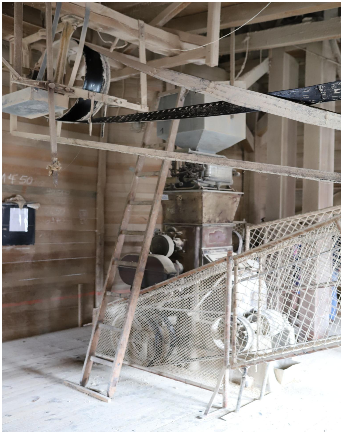
Zabytkowy śrutownik, umieszczony na ostatniej kondygnacji w browarze. Zdjęcie: https://www.kierunekspozywczy.pl/artykul,95063,tradycyjne-rzemioslo.html
